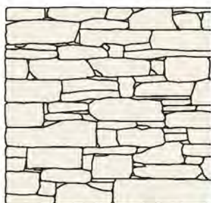
Irrégulier ou à tout-venant (pierres sèches sans mortier)
