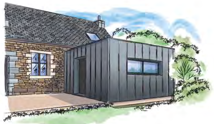
Extension cubique en bardage métallique
