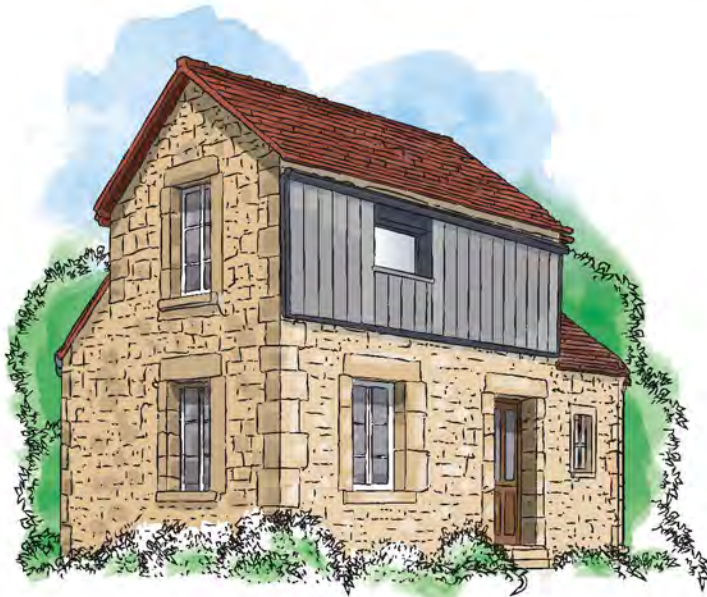
Toiture à deux pentes et bardage métallique
