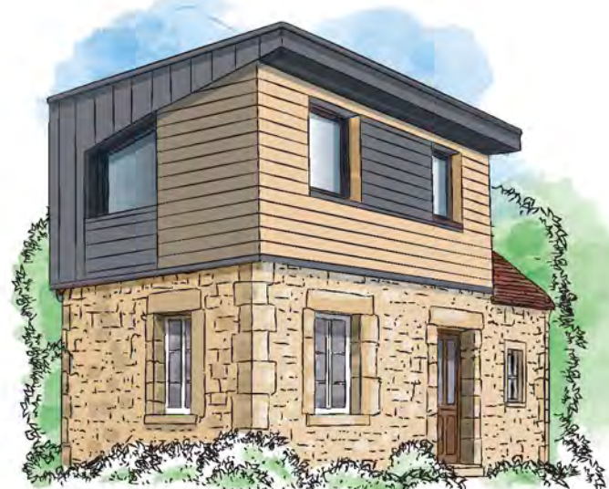
Toiture à une pente et bardage mixte bois/métal
