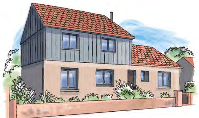
Surélévation en bardage métallique
