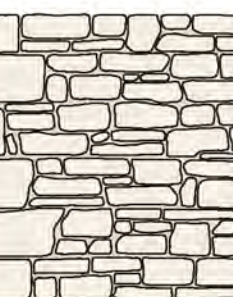
Assisé (moellons ébauchés)
